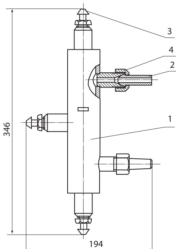
1- обечайка; 2- ниппель; 3- пробка; 4- гайка
